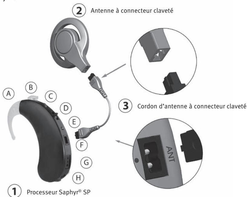
Le numéro de série de votre processeur Saphyr® SP est situé à l'intérieur du compartiment des piles : « N1495 » par exemple (N = génération du processeur/XXXX = numéro de fabrication).
