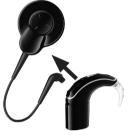
Tenez le câble d'antenne par les côtés antidérapants et tirez fermement pour le retirer du processeur. Ne tirez pas sur la partie flexible du câble d'antenne.
