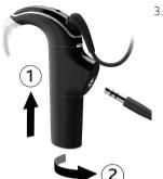
Insérez le module de batterie, puis tournez-le pour le connecter.
